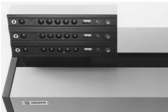
Elektronische Positionsanzeige für Werkzeugmaschinen
